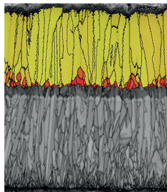
Bei Inveio® ist jeder Kristall in der Aluminiumbeschichtung in der gleichen Richtung angeordnet und erzeugt eine schützende Barriere in Richtung Schneidzone.
