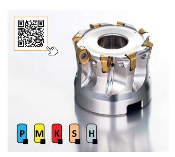
Produktive Hochvorschubbearbeitung unterschiedlichster Materialien. Die progressiven SBN10-Fräser sind für die meisten Fräsanwendungen geeignet. Sein einzigartiges Plattensitzdesign kann auch präzise ANHX-Wendeschneidplatten (DC = 16 - 42 mm) zum Schlichten von Wand und Boden aufnehmen und bietet ein Komplettpaket für Gesenk- und Formenanwendungen vom schnellen Schruppen bis zum Schlichten.
